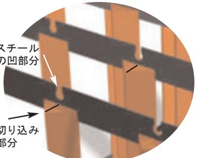
その際、スチールの凹部分と、角材の切込み部分の位置が合うよう調節を行って下さい。
