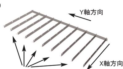
X軸方向のスチール凹部分が、必ず上方向になるよう組立てて下さい。
