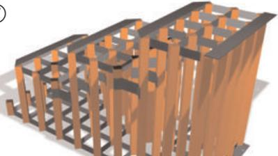
最下部になる部分にL字のスチール(Steel Angle Bottom)をハメ込みます。
