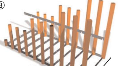
両端全てに角材をハメ込んだら、Y軸方向のスチールを全て差し込みます。
