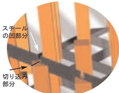
その際、スチールの凹部分と、角材の切り込み部分の位置が合うよう調節を行って下さい。
